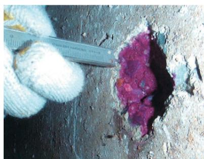
コンクリートの腐食(中性化)について、表面からの深さを調べる試験です。中性化試験結果から腐食環境や腐食程度・速度がわかります。
