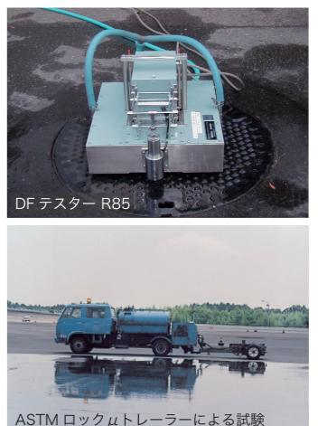
ASTM ロックムトレーラーによる試験
