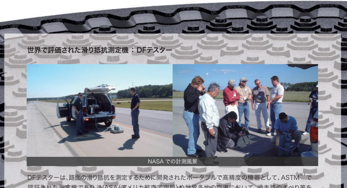
DF テスターは、路面の滑り抵抗を測定するために開発されたポータブルで高精度の機器として、ASTM<sup>※1</sup> で認証された測定機であり、NASA(アメリカ航空宇宙局)や世界各地の空港において、滑走路のすべり等を測定するためにも使用されている。
